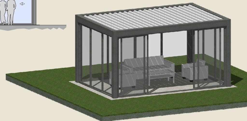
struttura portante in scatolare metallico zincato a caldo e verniciato a tinte RAL
