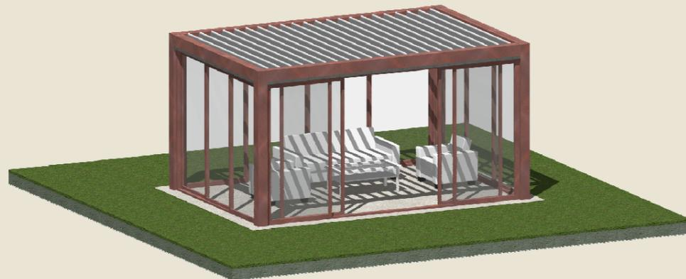
Modulo BASE con pergola a lamelle orientabili motorizzate e chiusure perimetrali con infissi in alluminio/vetro
